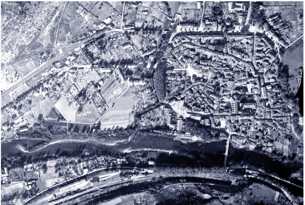
Débat sur les chaussées : ce document de 1946 (photographie aérienne publiée par l'IGN - source Géoportail) a été présenté : il montre le secteur de Saint-Antonin sans la chaussée de Roumégoux, alors détruite) : le cours d'eau est très différent, entre des bancs de sable.
